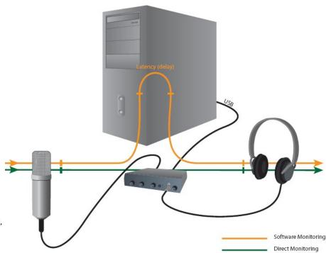
Прямой мониторинг дает возможность слышать сигнал инструмента или микрофона во время записи без задержки, неизбежной при прохождении его через компьютер.
